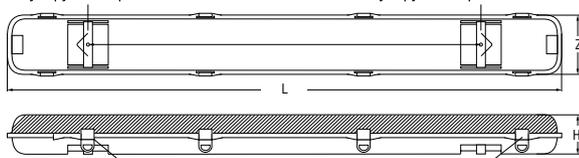
Специальные защелки для подвеса крышки светильника при обслуживании
